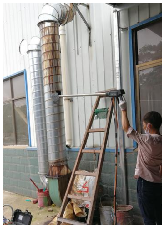
排气筒 G1 出口（颗粒物）
