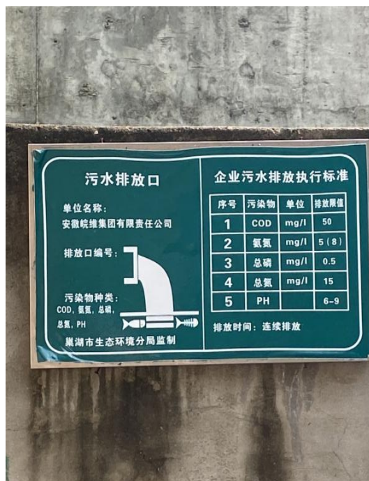
废水排放口标识牌（依托）
